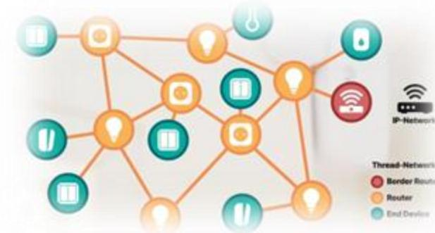
Un costruttore può tenere le credenziali delle sue reti Thread per sé, senza scriverle nel portachiavi generale di Android o iOS. Pertanto, i router di confine di altre marche, non potranno diventare parte della rete mesh gestita da quel costruttore.
